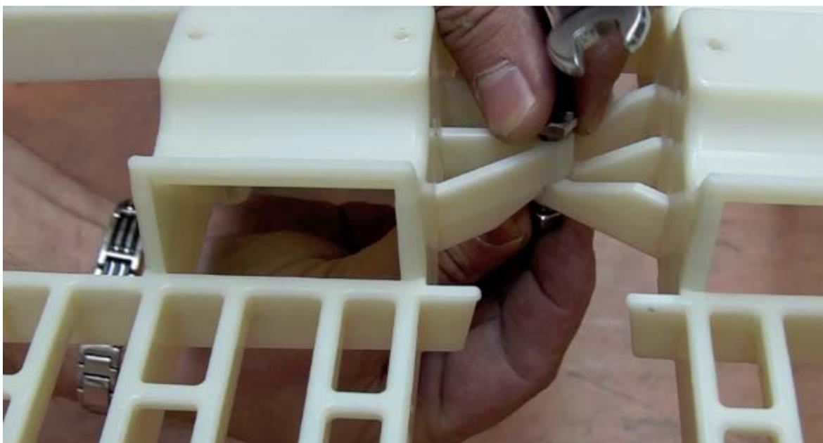
Attention, sur la photo, il est représenté un boulon (vis et écrou) alors que maintenant on fixe une vis.
