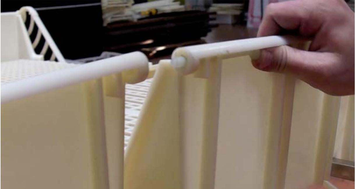
Insérer la tige dans la 1<sup>er</sup> cage, puis à travers la cloison et continuer jusqu'à la 2<sup>eme</sup> cage
