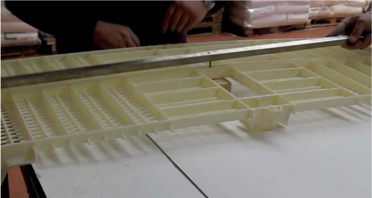
Introduire la vis dans les caillebotis, puis dans le pied et venir serrer avec la clef. La partie bombée de la vis doit être situé côté caillebotis (canards)
